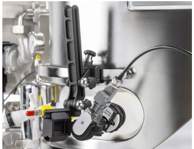
Sartorius의 BioPAT® Spectro 싱글-유즈 포트를 사용해 Biostat STR®에 연결된 Raman 프로브 Rxn-46
